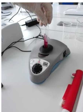
Rys. 9.9. Kolejne czynności podczas wykonania ćwiczenia (od lewej: umieszczenie próbki w komorze pomiarowej; mieszanie roztworu na mieszadle typu VORTEX; odczyt absorbancji próbki)
