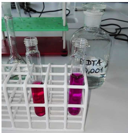
Rys. 9.7. Próbką zawierająca jony \text{Ni}^{2+} oraz wskaźnik (mureksyd) o kolorze czerwonym oraz ta sama próbka po dodaniu titranta (EDTA)
