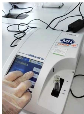
Rys. 9.9. Kolejne czynności podczas wykonania ćwiczenia (od lewej: umieszczenie próbki w komorze pomiarowej; mieszanie roztworu na mieszadle typu VORTEX; odczyt absorbancji próbki)
