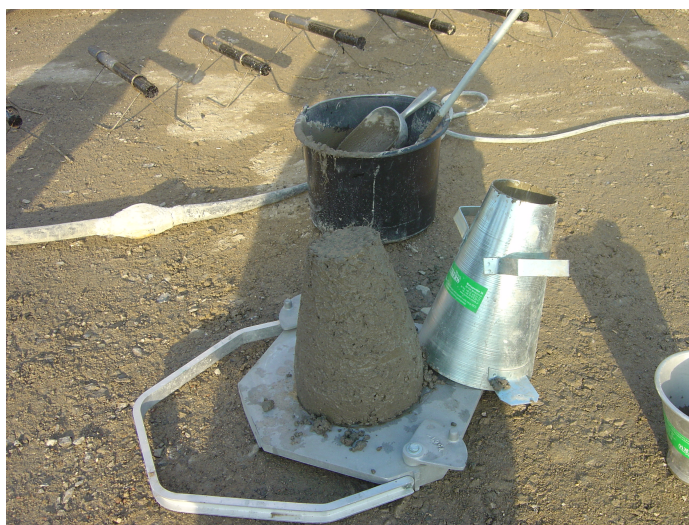
Rys. 4.8. Badanie konsystencji mieszanki betonowej na placu budowy. Fot. Autor
