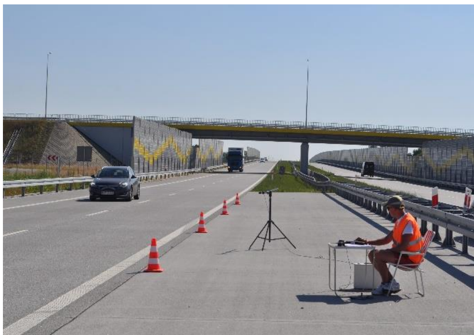
Pomiary hałasu toczenia pojazdów samochodowych metodą statystycznego przejazdu na drodze ekspresowej S8 (m. Złoczew - woj. łódzkie)
