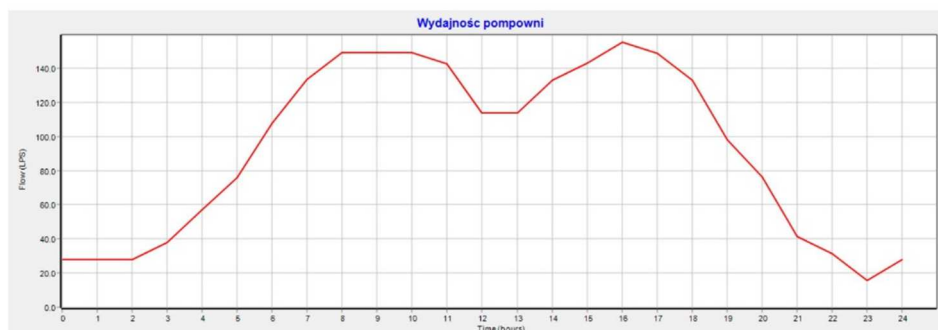
Rys. 64. Zmienność wydajności pompowni w ciągu doby
